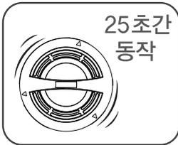
7. 25초간 동작 후 자동으로 정지 합니다. 동작 중 정지는 뚜껑스위치를 왼쪽으로 돌리면 정지합니다.
