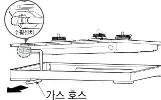
낮은 타입 가스쿠타스탠드케이스의 경우 가스 호스 연결 후 연결부가 수평이 되게 설치하여 주십시오. 제품 높이가 낮기때문에 가스 호스가 닿아 설치가 어려울 수 있습니다.
