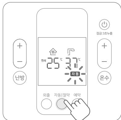
1. 在电源打开的状态下, 按下[自动|节约]按钮, 开始执行节约模式。
