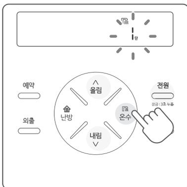
1. 在打开电源的状态下, 按下[热水]按钮, 开始供应热水。
