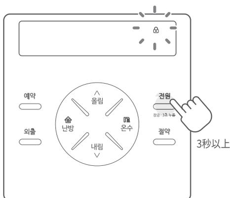
1. 在电源打开的状态下, 按下[电源]3秒以上, 即可设置锁定。
