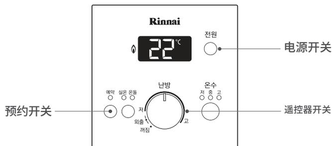
1 请打开电源,把遥控器开关转动到“底-高”区间,设定需要的暖房温度。
