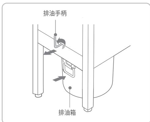
1. 将排油箱放置在抽油孔下方。
