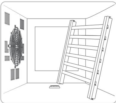
3. 将搁板和鼓风机导向装置拆下后，朝右侧方向（对吹风机的对向）倾斜放置。
