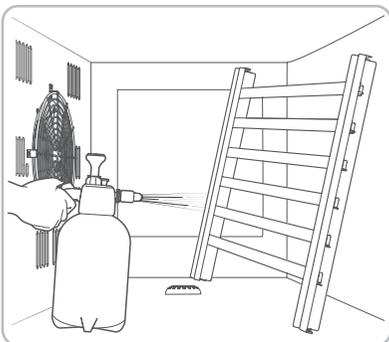
4. 利用清洗剂喷雾器向烤箱内部均匀地喷洒清洗剂，然后将烤箱门关上。
